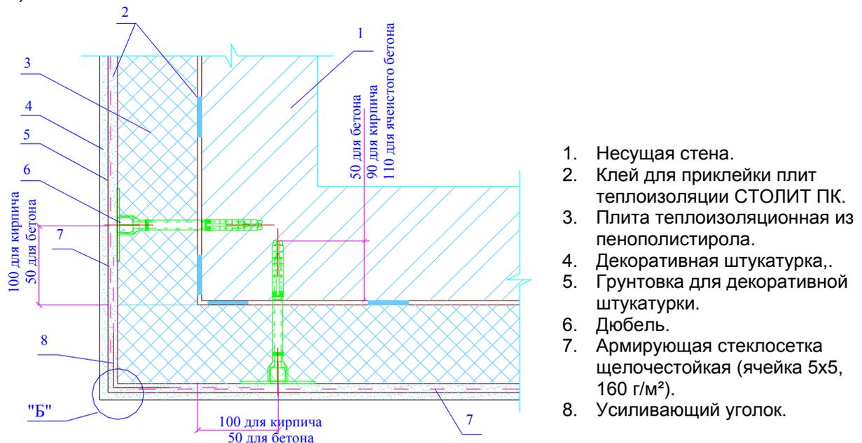
**Рисунок 11.** Утепление стен, образующих внешний угол.
