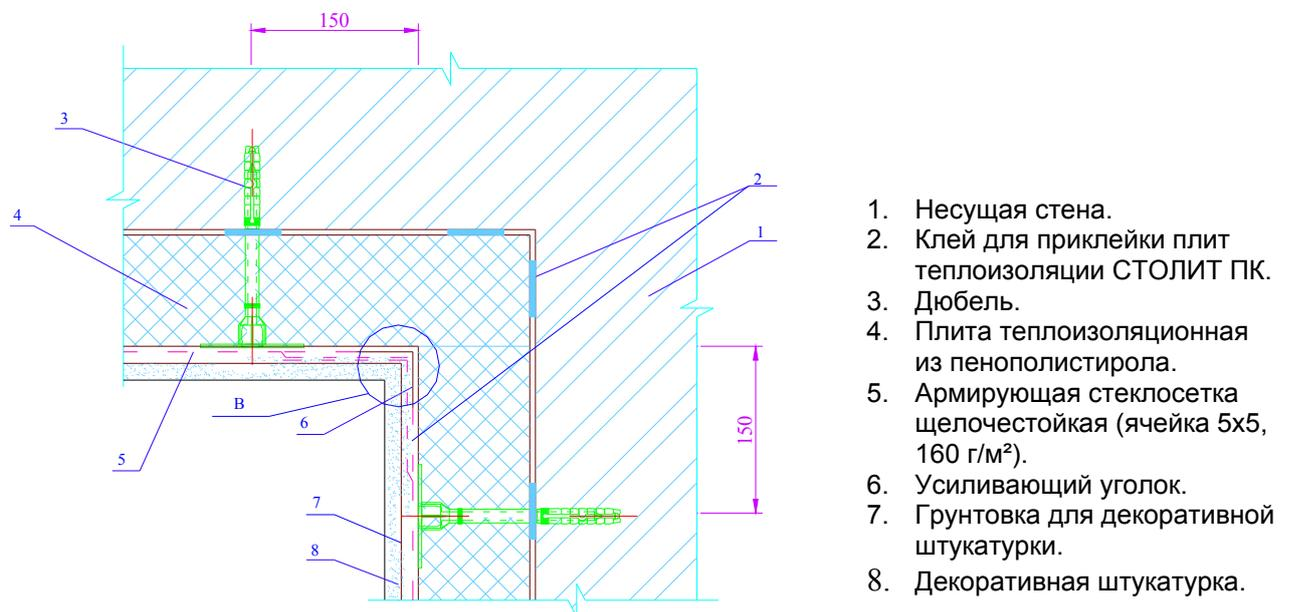
**Рисунок 13.** Утепление стен, образующих внутренний угол.
