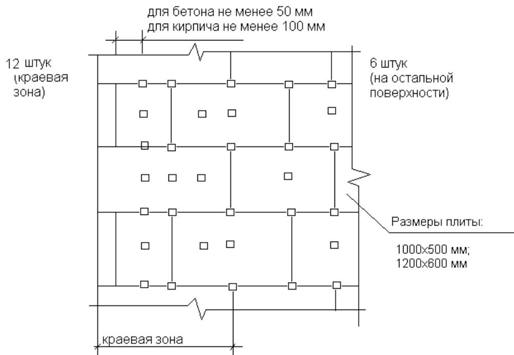
**Рисунок 9.** Схема расположения дюбелей в краевой зоне.
