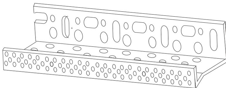
**Рисунок 1.** Перфорированный цокольных профиль, подготовленный к установке.
