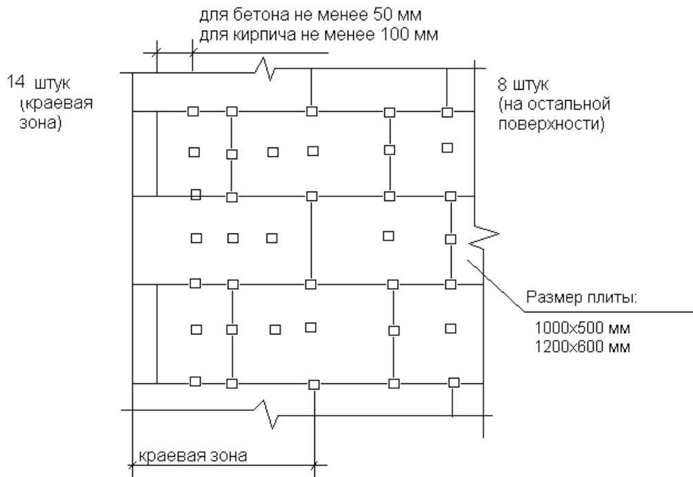
**Рисунок 10.** Схема расположения дюбелей в краевой зоне .
