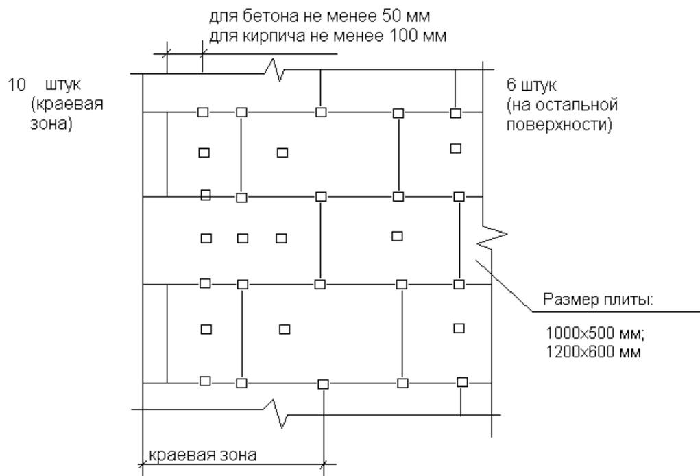
**Рисунок 8.** Схема расположения дюбелей в краевой зоне.
