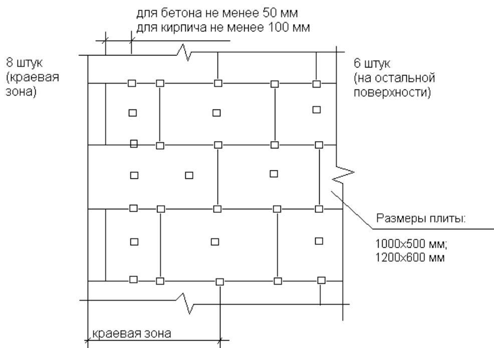
**Рисунок 7.** Схема расположения дюбелей в краевой зоне.
